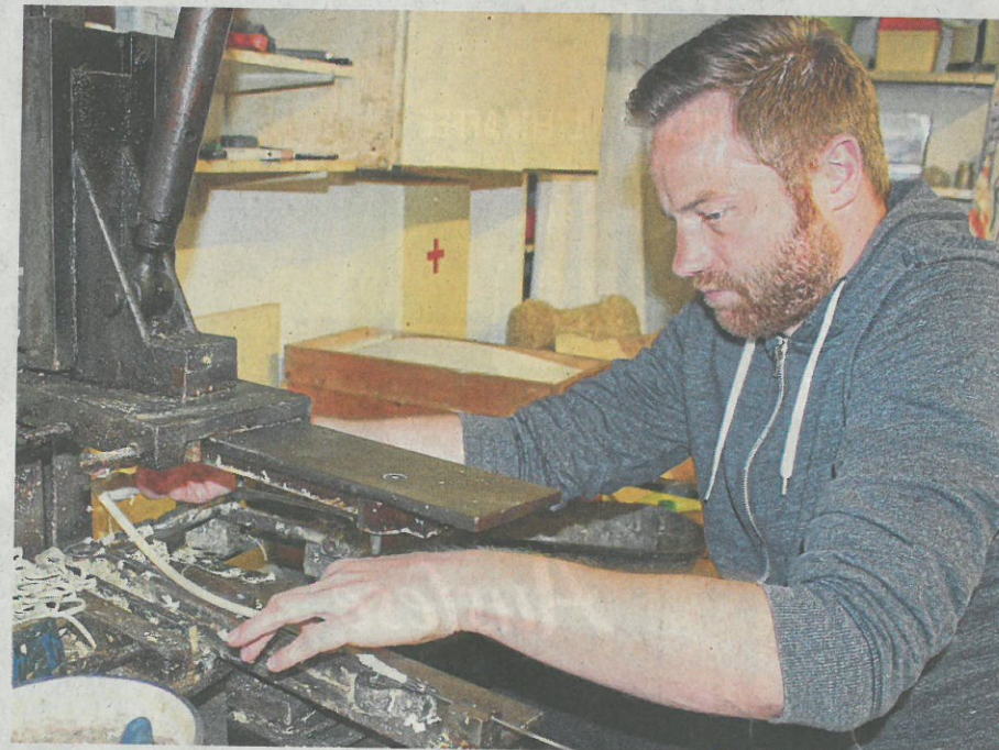
Die Werkstatt von Jens Steuler in Hilgert ist die einzige in Deutschland, in der Tonpfeifen noch mit dem traditionellen Stanzverfahren hergestellt werden (linkes Foto). Stolz präsentieren Steuler und Davide Valentino die verschiedenen Pfeifen, die sie im Sortiment haben (rechtes Foto).
